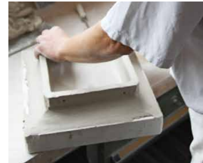
Nach der Aushärtung werden alle Teile von Hand abgerichtet, zugeschnitten und verputzt.
