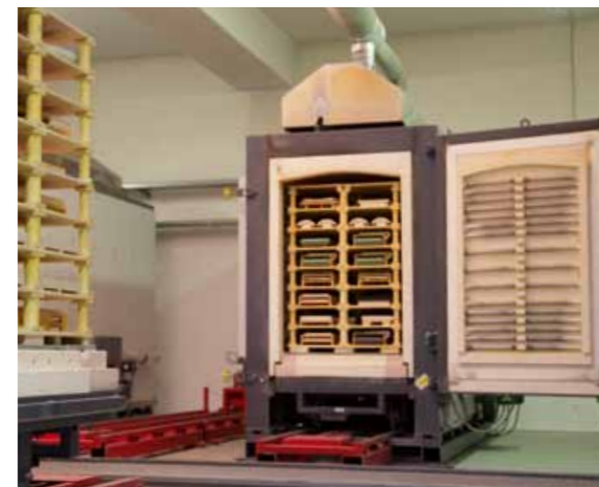
Bei Temperaturen über 1000 °C werden die Keramikteile in unseren umweltgerechten elektrischen Öfen gebrannt.
