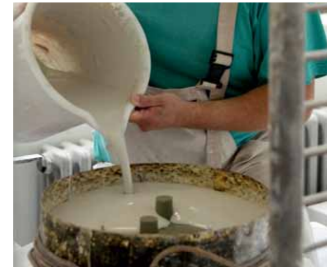
Die unterschiedlichen keramischen Rohlinge werden mithilfe von Gipsformen hergestellt.
